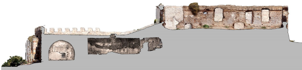
Fig. 4- Castillo de Petrés, Valencia. Sección que integra fotogrametría y escáner láser 3D. (Rodríguez-Navarro, Gil-Piqueras & Pérez-Vila)
