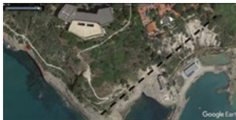
Fig. 3- Per confronto, l'immagine satellitare attuale: l'arretramento del ciglio superiore della falesia è pari a circa 28-30 metri
